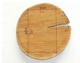
Figura 1.9: Influenza della perdita di umidità sulla forma del segato.
