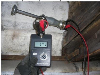
Figura 5.4: L'igrometro a resistenza.
