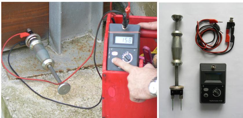
Figura 1.7: L'umidità del legno si può misurare in cantiere per mezzo di igrometri elettrici, apparecchi che misurano la resistenza elettrica fra due elettrodi (chiodi) infissi nel legno la quale è correlata con l'umidità del legno.
