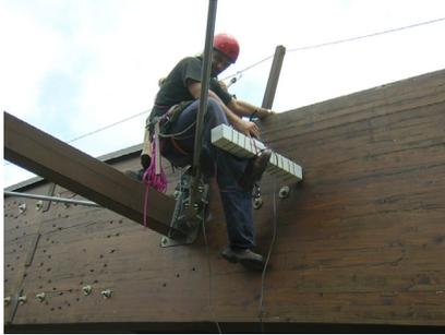
*Figura 5.5: Il trapano dinamometrico è uno degli strumenti più utilizzati nella diagnosi delle grandi strutture lignee, e consente, con qualche accorgimento, di lavorare in condizioni disagiate senza pregiudizio per la sicurezza dell'operatore che, nell'immagine, è dotato di imbracatura assicurata alla linea vita già presente sulla struttura in quanto prevista in fase di progetto.*
